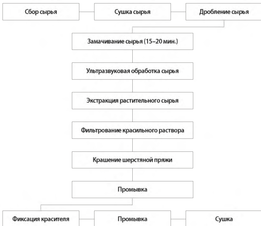
Рис. 1. Технология крашения шерстяной пряжи природными красителями
