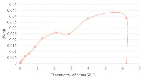
Рисунок 4 — Кривая скорости сушки ткани с PU покрытием с кратностью 1,5
