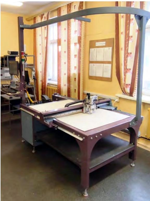
**Рисунок 2 — Общий вид раскройного комплекса АРК1500**
