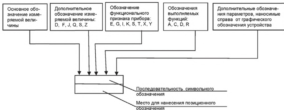
Рисунок 5 – Принцип построение условного обозначения прибора
