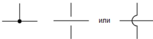
Рисунок 4 – Условные обозначения соединения и пересечения трубопроводов
