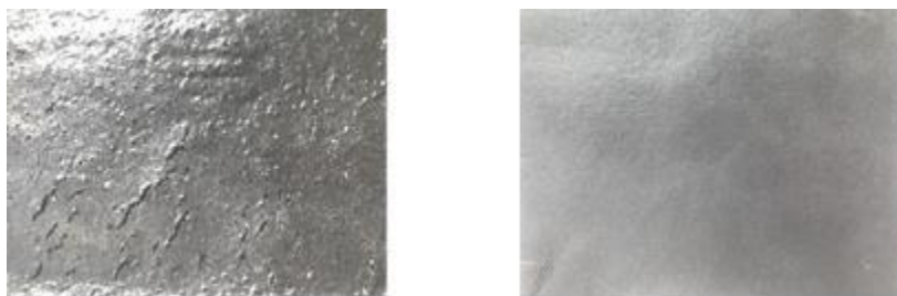
Рисунок 3 – Фотография поверхности полимерного покрытия после сушки: а – СВЧ, б - конвективно-терморрадиационная сушка
