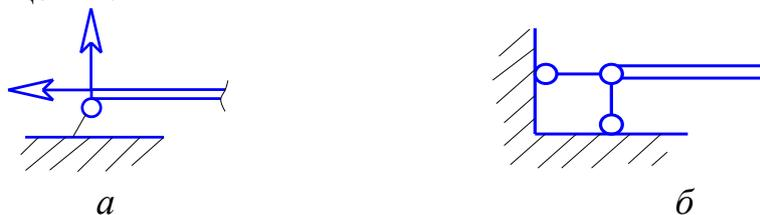
Рис. 5.3 – Шарнирно-неподвижная опора
