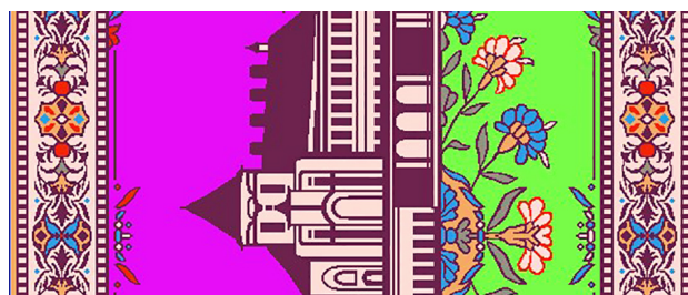
Рисунок 3 – Фрагмент технического рисунка с распределением отвлеченных цветов для обозначения различных модельных переплетений
