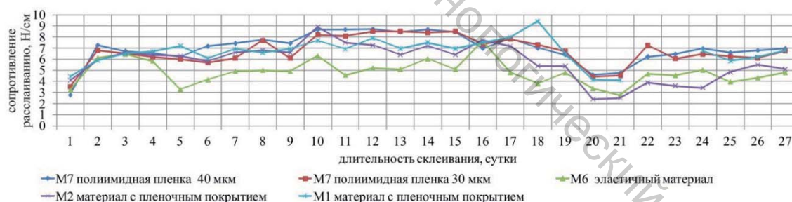
Рисунок 1 – Динамика изменения S_p после получения клеевого соединения
