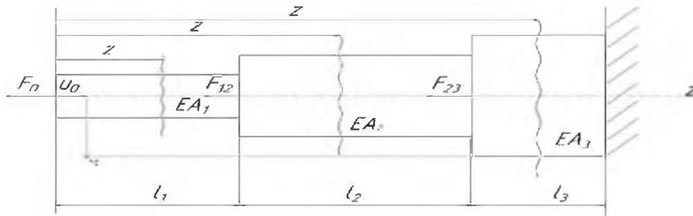
Рисунок 3 – Растяжение ступенчатого стержня
