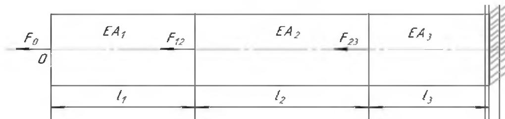
Рисунок 4 — Эквивалентная модель ступенчатого стержня
