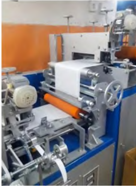
Рисунок 1 – Узел для разрезания спанбонда на поточной линии
