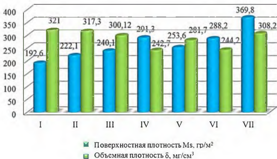
Рисунок 2 – Поверхностная и объемная плотность трикотажа
