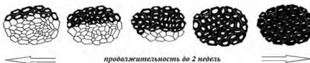
Рисунок 2 – Особенности утолщения вторичной стенки элементарного волокна в пучке [7]
