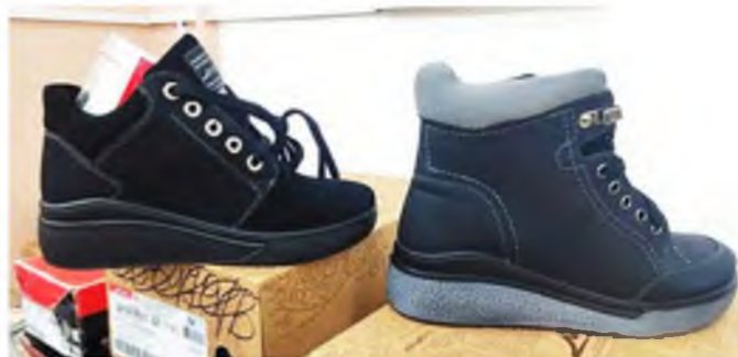
Рисунок 5 – Обувь до и после окрашивания боковой поверхности подошвы
