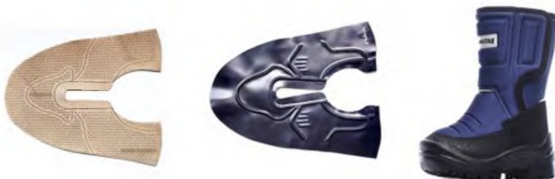
Рисунок 2 – Заготовки и обувь, декорированные тиснением
