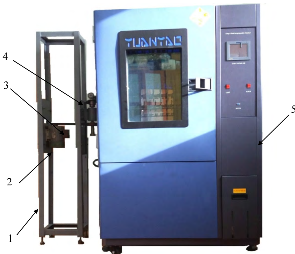
Рисунок 11.1 – Климатическая камера УТН-408-40-1Р с приводом:
