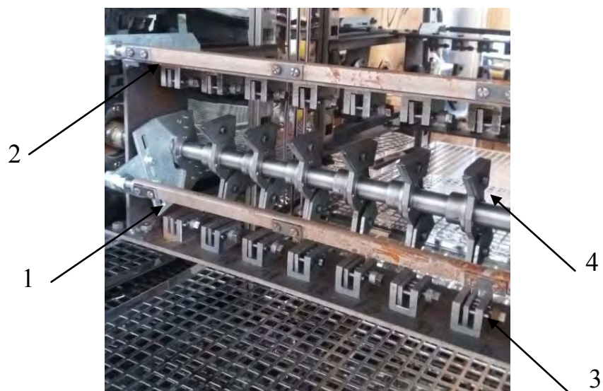
Рисунок 11.2 – Внешний вид зажимов установке для исследования эксплуатационных свойств материалов:
