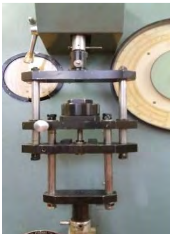
Рисунок 6.1 – Устройство к разрывной машине для оценки свойств материалов верха обуви сферическим растяжением:
