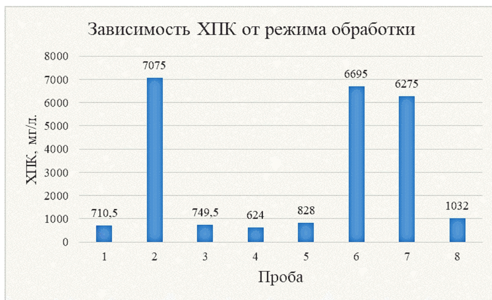
Рисунок 5 – Графические зависимости значения показателя качества сточных вод текстильного производства «ХПК» (ПДК = 1200 мгО 2 /л) от режимов обработки: 1–8 – варианты воздействия на СВ, описанные в методике экспериментальных исследований
