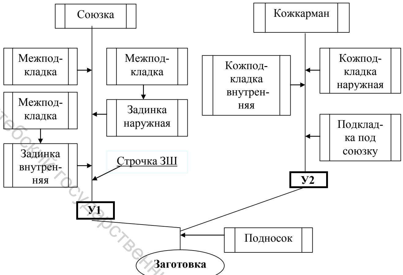
Рис. 1.1. Схема сборки заготовки
