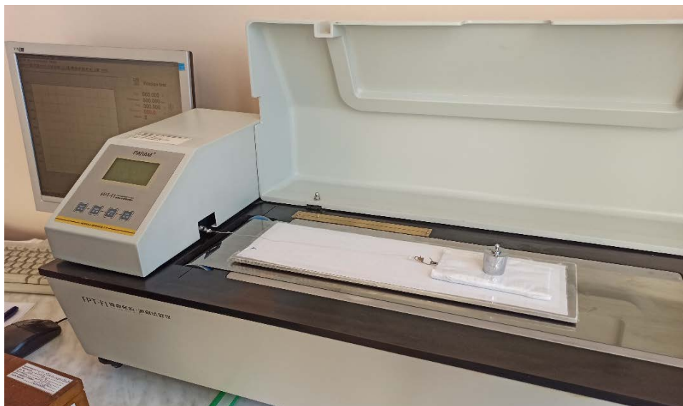
Рисунок 2 – Определение коэффициента тангенциального сопротивления тканей на приборе FPT-F1
