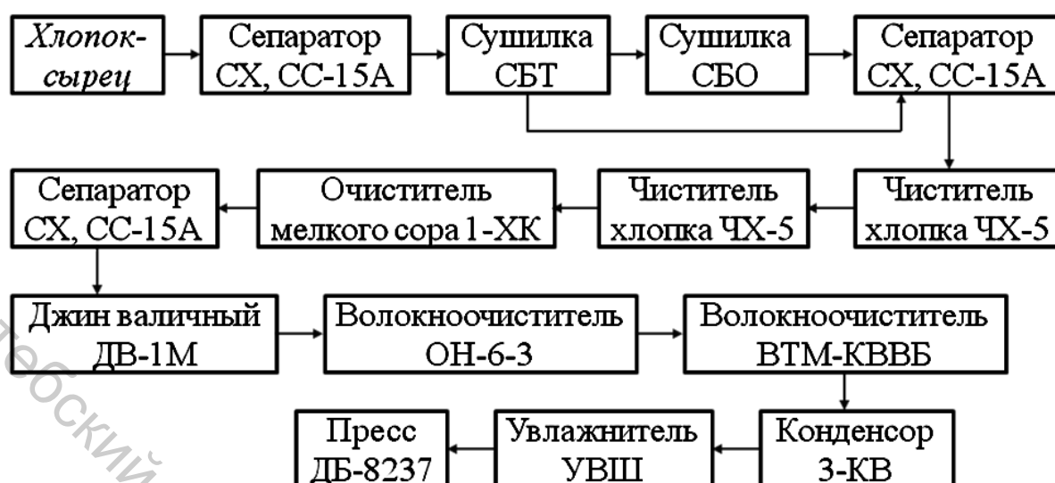
Рисунок 1.7 – Схема завода валичного волокноотделения
