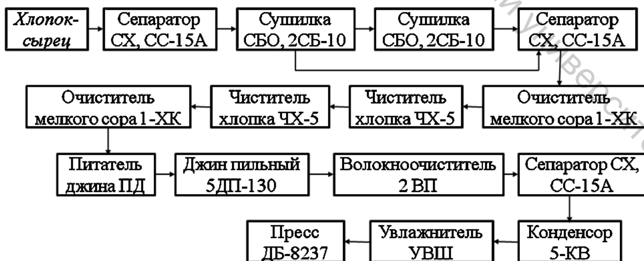
Рисунок 1.6 – Схема завода пыльного волокноотделения
