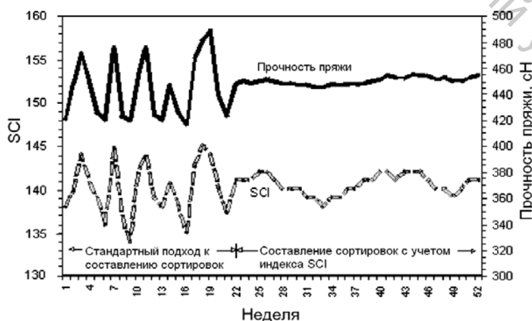
Рисунок 4.3 – Влияние использования индекса SCI при составлении сортировок на прочность хлопчатобумажной пряжи
