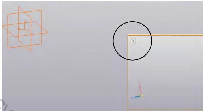
Рисунок 1.4 – Вкладка копирования детали в графической части САПР
