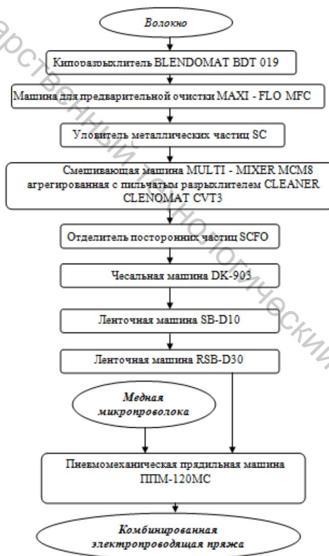
Рисунок 5 – Принципиальная схема технологической линии для выработки комбинированной электропроводящей пряжи
