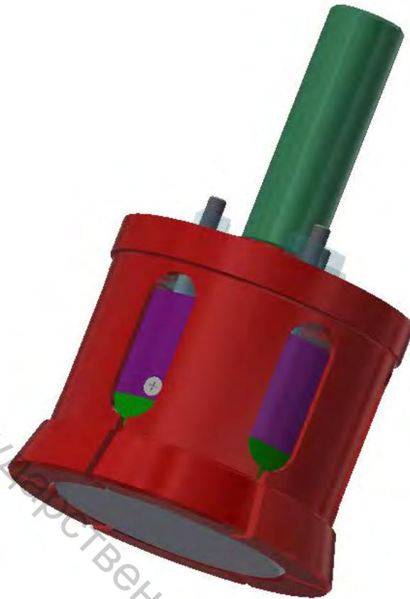
Рисунок 5.40 – Головка пневматического патрона для зажима кольца по наружной поверхности. Вид с выключенной видимостью некоторых элементов
