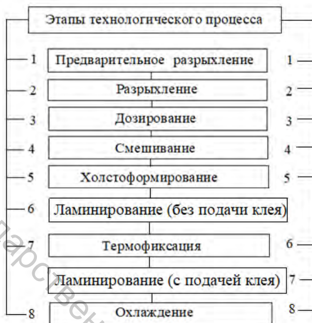
Рисунок 4.3 – Технологический процесс производства нетканых композиционных ламинированных материалов
