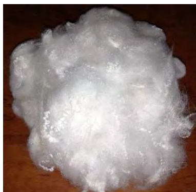
Рисунок 3.18 – Внешний вид полиэфирного бикомпонентного волокна марки 4DE51
