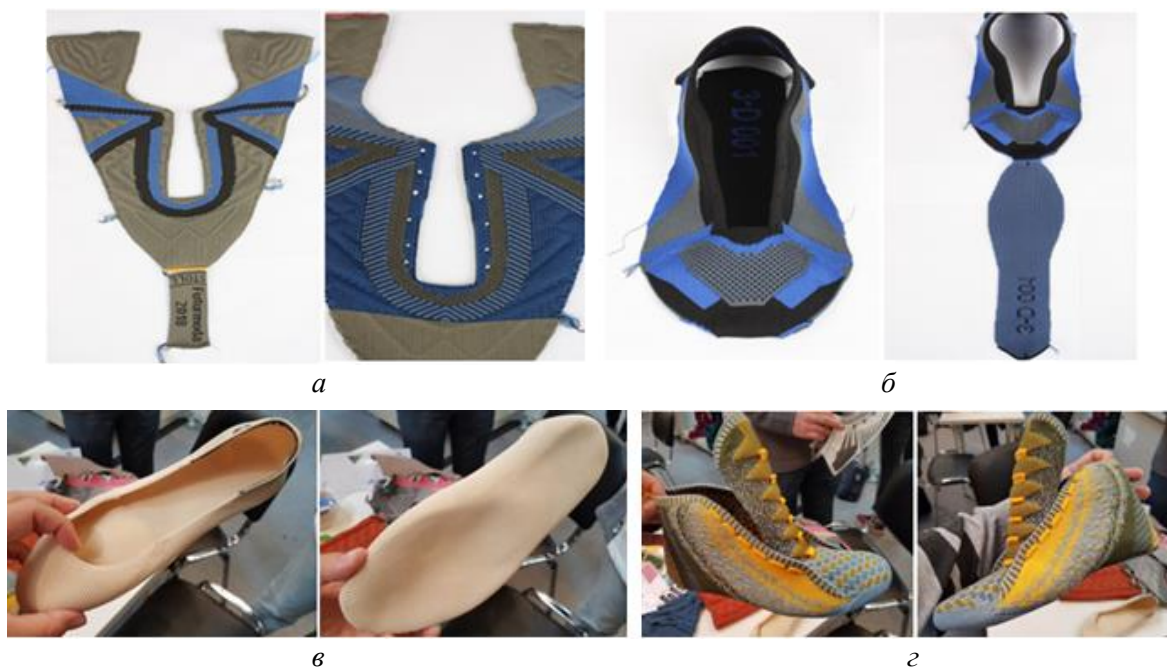
Рисунок 3 – Типы заготовок верха плетеной обуви: плоская (а), объемная (б), объемная без имитации отдельных деталей (в), объемная с имитацией отдельных деталей (г)
