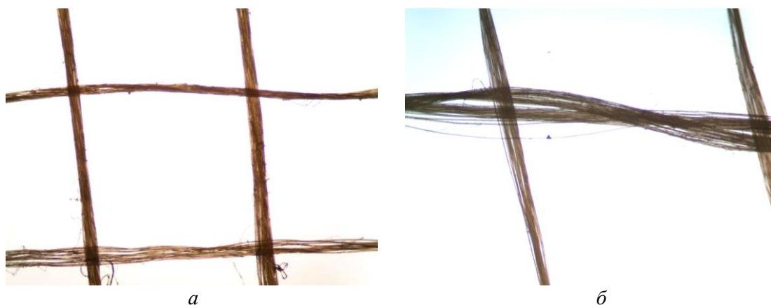
Рисунок 1 – Структурный элемент ткани полотняного (а) и перевивочного (б) переплетения на базе арамидных нитей 3,3 текс
