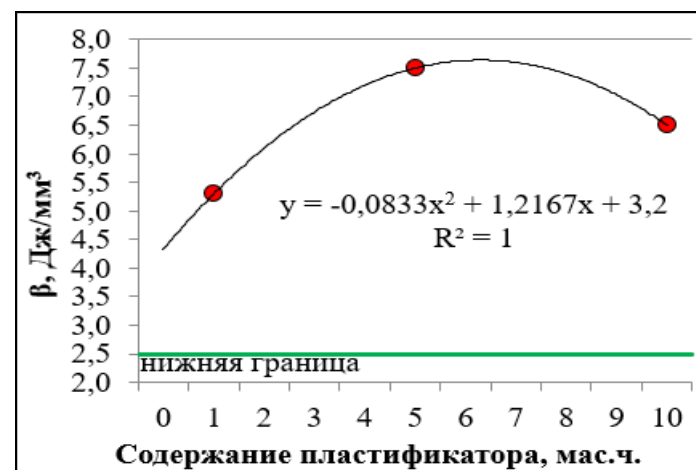
Рисунок 3.24 – Сопротивление истиранию монолитных образцов в зависимости от содержания пластификатора
