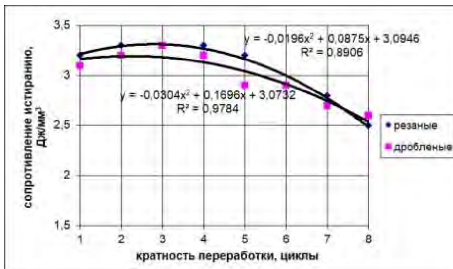
Рисунок 2.25 – Зависимость свойств вторичных композиционных материалов от кратности переработки и степени диспергирования
