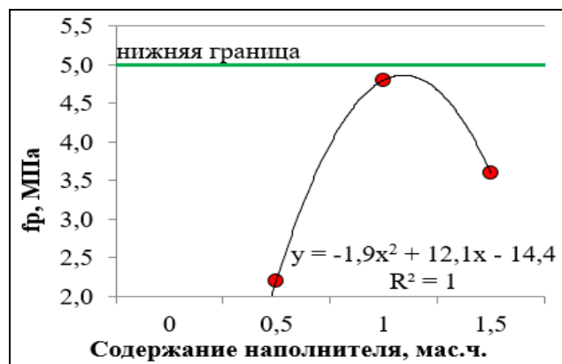
Рисунок 3.30 – Условная прочность волокнисто-наполненных образцов в зависимости от содержания наполнителя
