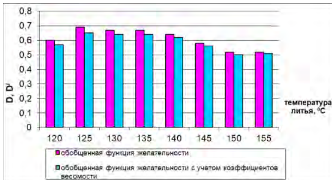
Рисунок 2.18 – Диаграмма распределения значений обобщенной функции желательности при увеличении температуры литья
