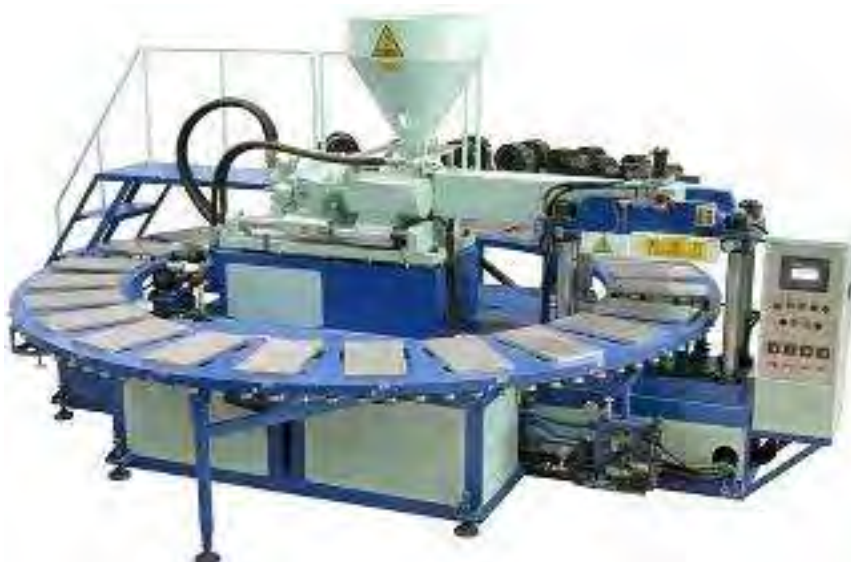
Рисунок 1.4 – Агрегат для жидкого формования карусельного типа
