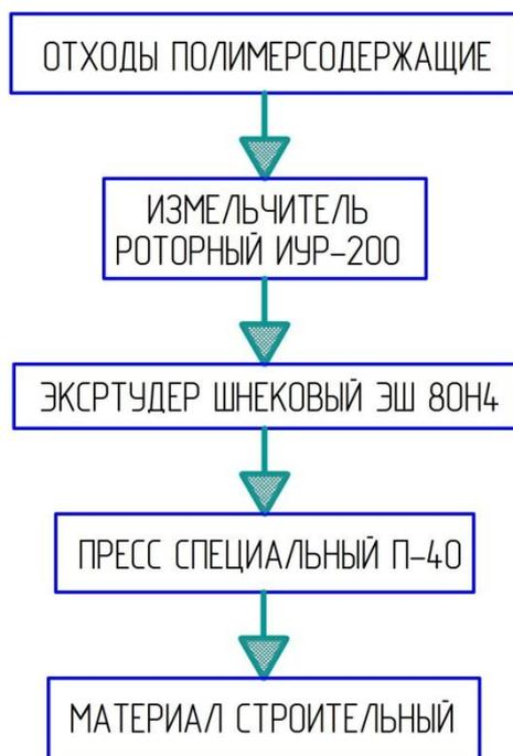
Для получения материалов последовательно применяется следующее оборудование: измельчитель роторный ИУР-200 (для измельчения отходов); экструдер шнековый ЭШ-80Н4 (для термомеханического рециклинга и предварительного формования) и пресс специальный П 40 (для прессования материала).
