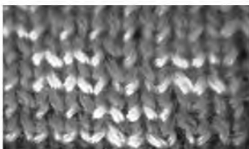
Рис. 1 – Визуальное изображение структуры кулирного двойного трикотажа жаккардовых переплетений: а) лицевая сторона. б) изнаночная сторона
