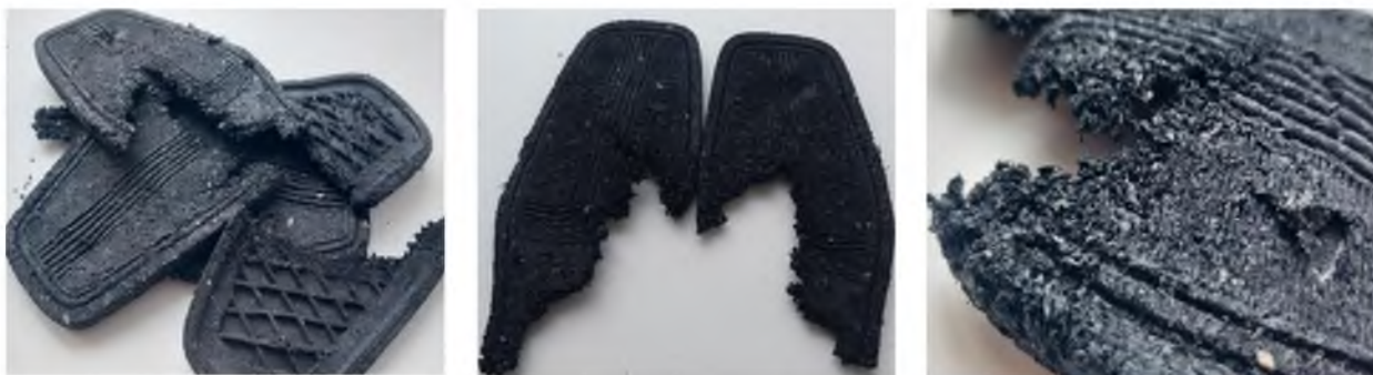
Рисунок 2 – Несформированные подошвы с волокнистым наполнителем более 6 мм
