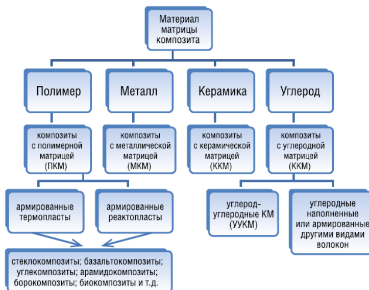
Рисунок 1 – Классификация материалов матриц композитов [3]
