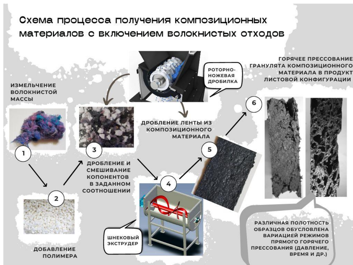
Рисунок 1 – Схема получения РКМ с включением текстильных отходов (двукратное дробление)
