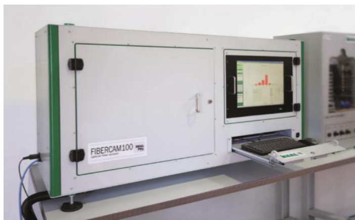
Рисунок 1 – Оптический лабораторный сортировщик волокна FiberCam100
