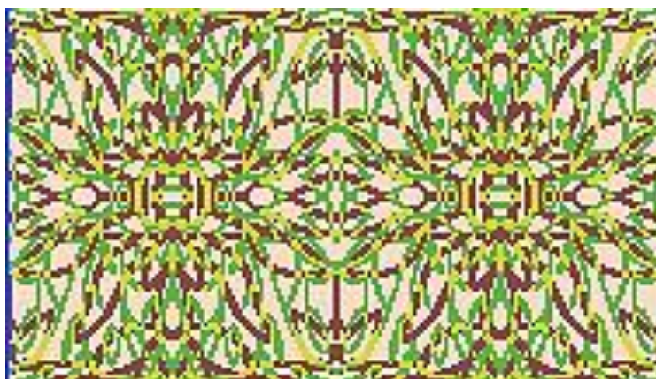
Рисунок 2 – Технический рисунок двухсторонней жаккардовой ткани полой структуры
