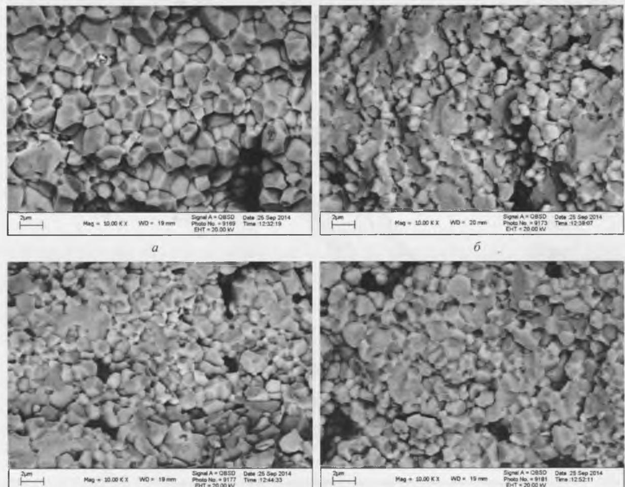
Рис. 4. Микроструктура поверхности излома керамических образцов ЦТС с различным временем механоактивации:  $a$  – без УЗВ;  $b$  – УЗВ 30 мин;  $c$  – УЗВ 60 мин;  $d$  – УЗВ 90 мин
