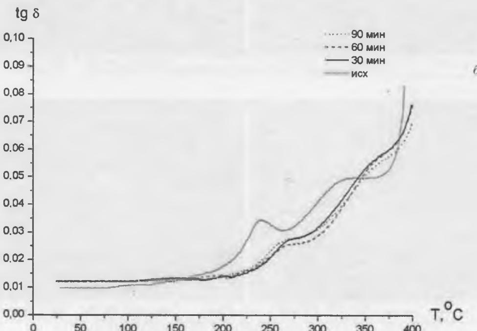
Рис. 3. Температурные зависимости диэлектрической проницаемости (а) и тангенса диэлектрических потерь (б) образцов ЦТС для различных времен УЗВ
