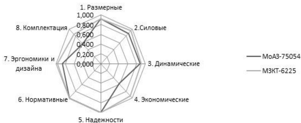
Рисунок 2 – «Радар» конкурентоспособности автосамосвалов
