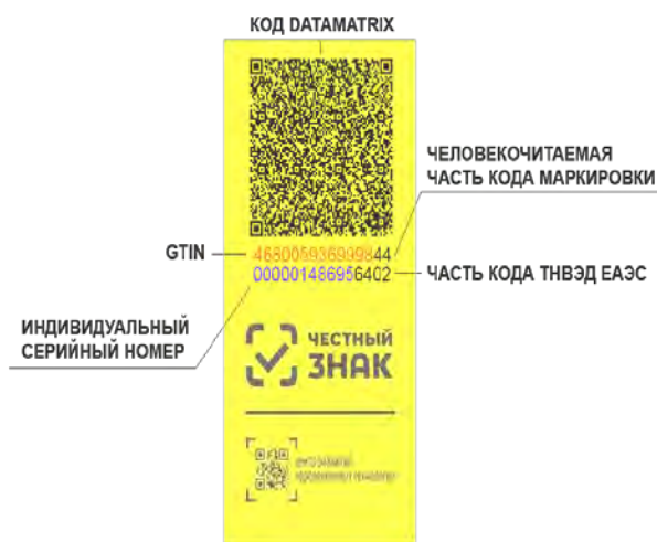
Рисунок 5.1 – Маркировка фотоаппарата кодами DataMatrix
