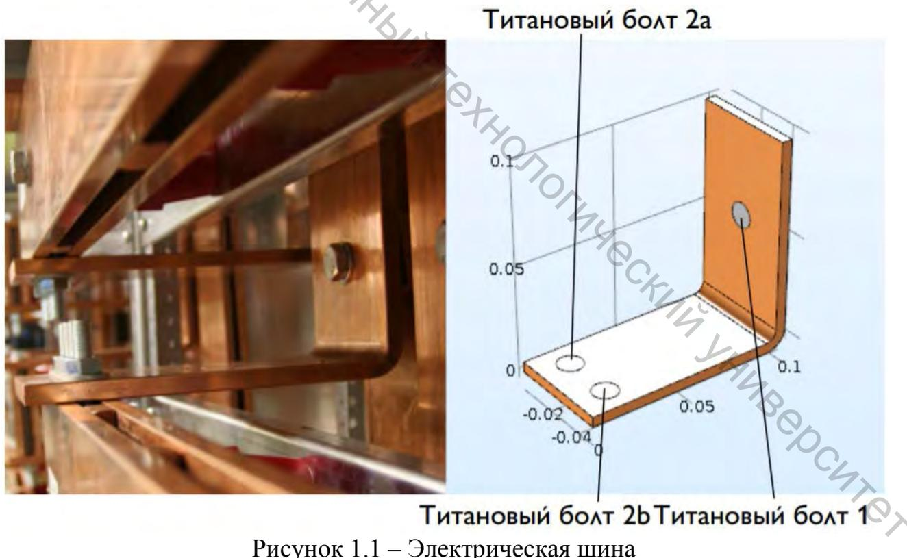
Рисунок 1.1 – Электрическая шина
