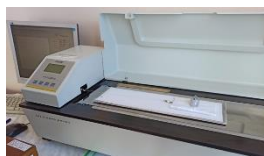
Рисунок 3 – Определение коэффициента тангенциального сопротивления тканей на приборе FPT-F1
