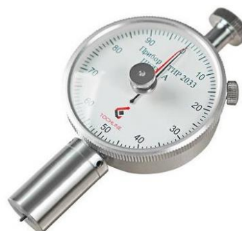
Рисунок 1 – Внешний вид твердомера 2033 ТИР
