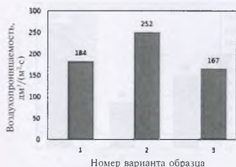
Рис. 10. Воздухопроницаемость образцов трикотажа.
