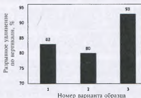
Рис. 6. Разрывное удлинение образцов трикотажа по вертикали.
