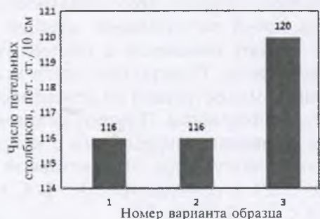
Рис. 2. Число петельных столбиков в образцах трикотажного полотна.
