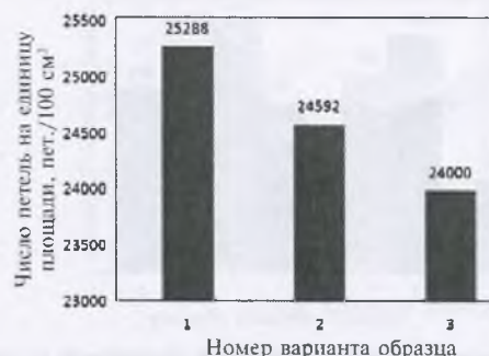
Рис. 11. Число петель на единицу площади трикотажа.
