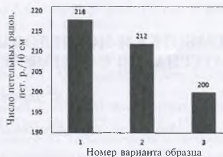
Рис. 3. Число петельных рядов в образцах трикотажного полотна.
