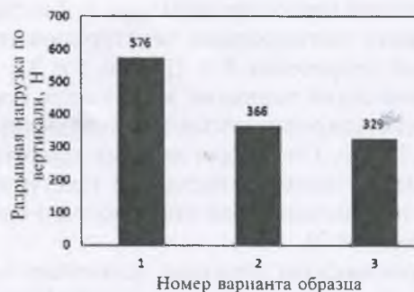
Рис. 4. Разрывная нагрузка образцов трикотажа по вертикали.
