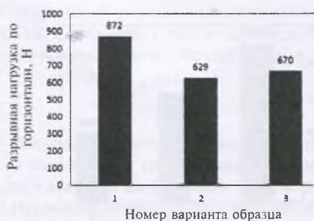
Рис. 5. Разрывная нагрузка образцов трикотажа по горизонтали.
