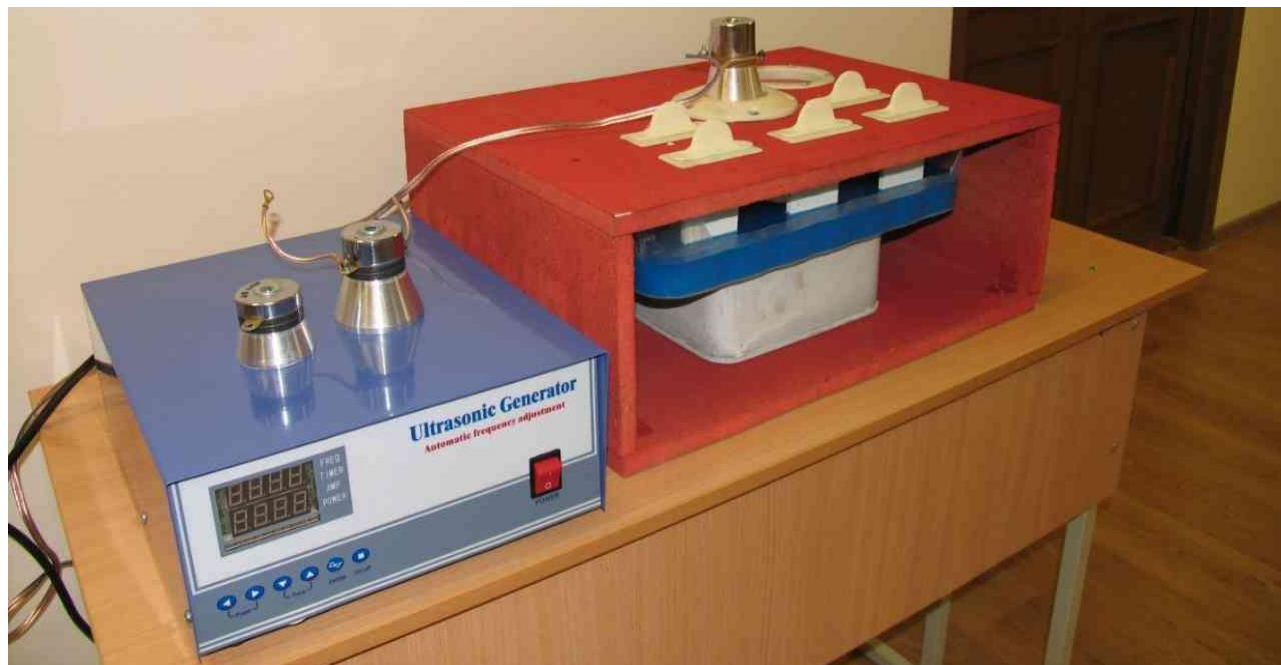
Рис. 2. Экспериментальная установка для исследования процессов крашения и промывки тканей
