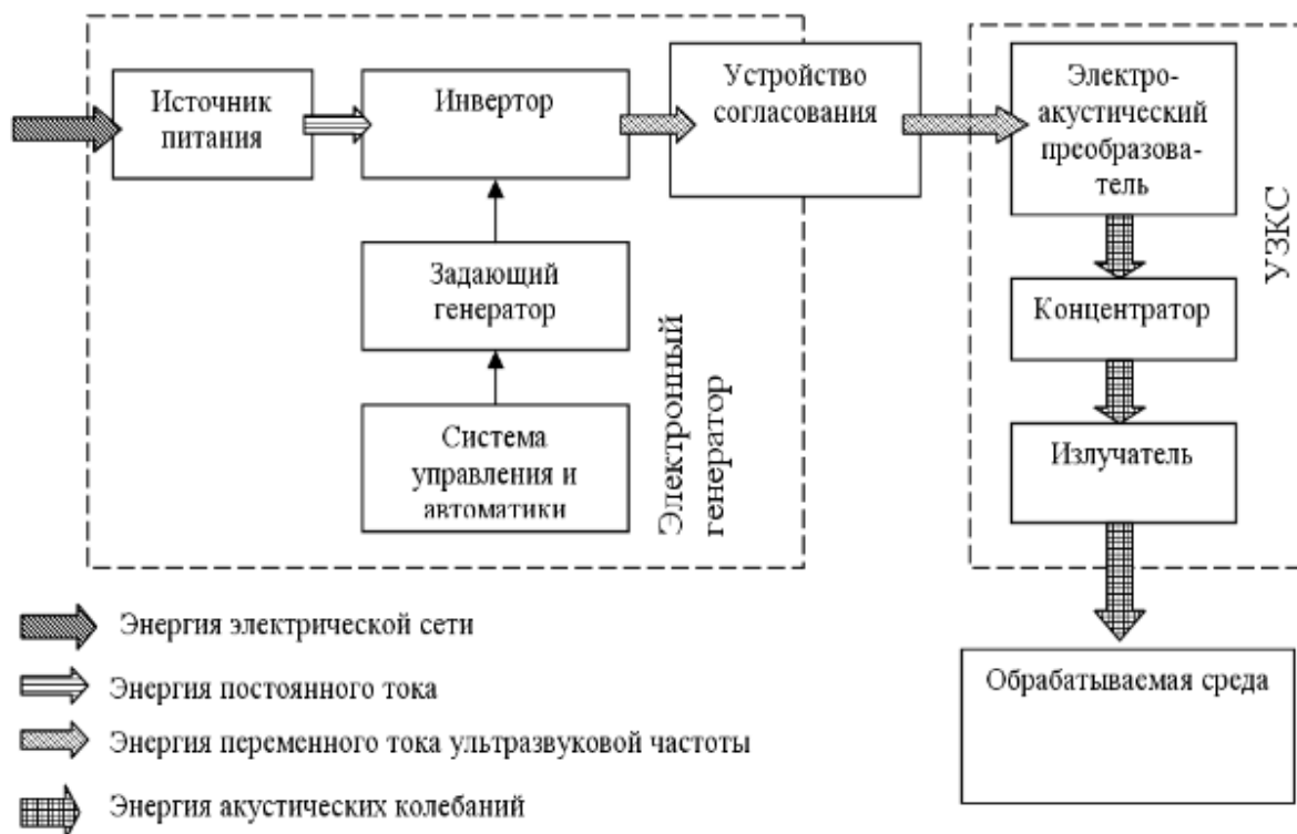
Рис. 1. Схема ультразвукового аппарата
