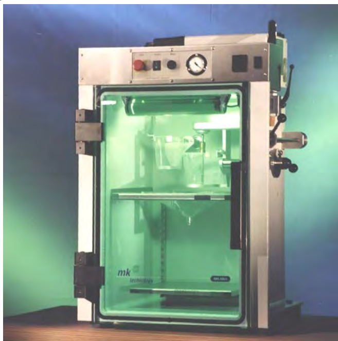
Рисунок 2.1 — Внешний вид установки вакуумного литья MK-MINI
