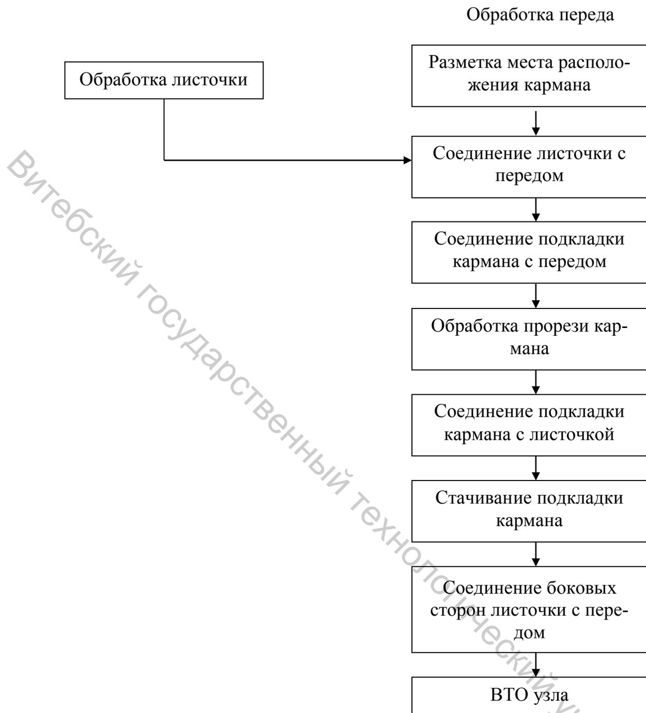
Рисунок 2.1 – Блок-схема обработки верхнего прорезного кармана с листочкой
