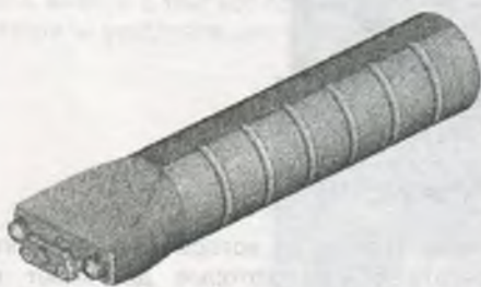
Рисунок 2 – Датчик тягового усилия пряжи - открытый
