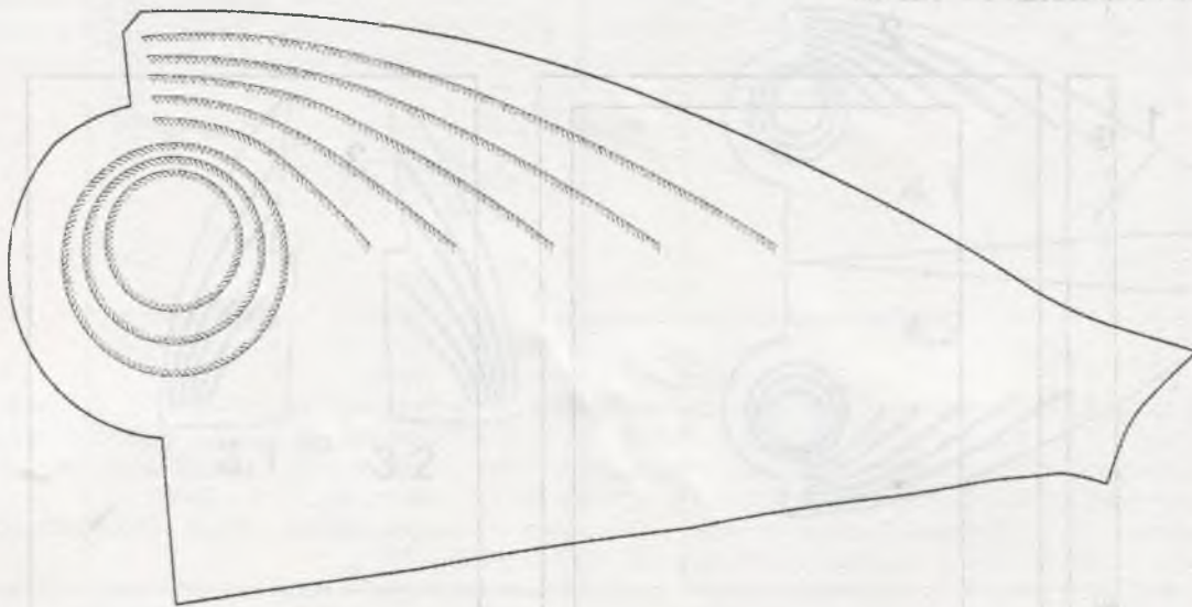
Рисунок 1 – Деталь заготовки верха обуви с ажурной строчкой «гладьевого валика»
