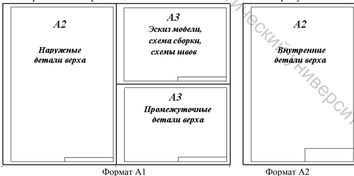
Рисунок 1.3 – Пример размещения чертежей сапог
