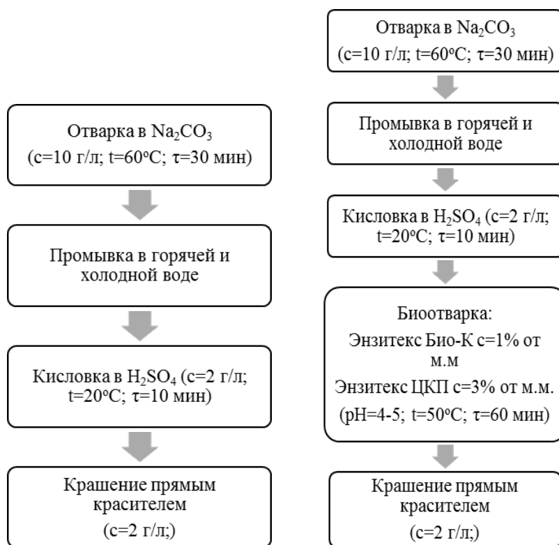
Рисунок 1 – Схема обработки отбеленной хлопчатобумажной ткани по: а – классической технологии, б – биотехнологии
