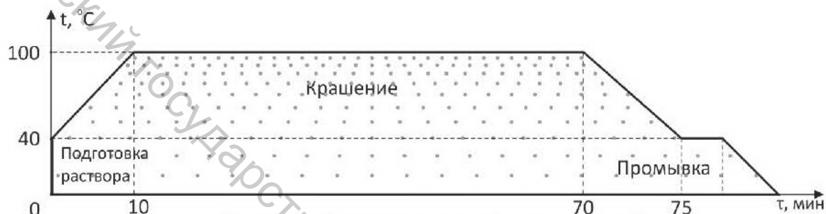
Рисунок 2 – Схема крашения традиционным способом
