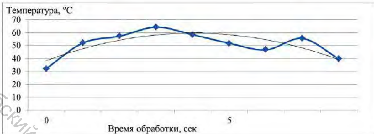
Рисунок 12 – Зависимость значений температуры от времени при чистовой обработке сферической поверхности детали
