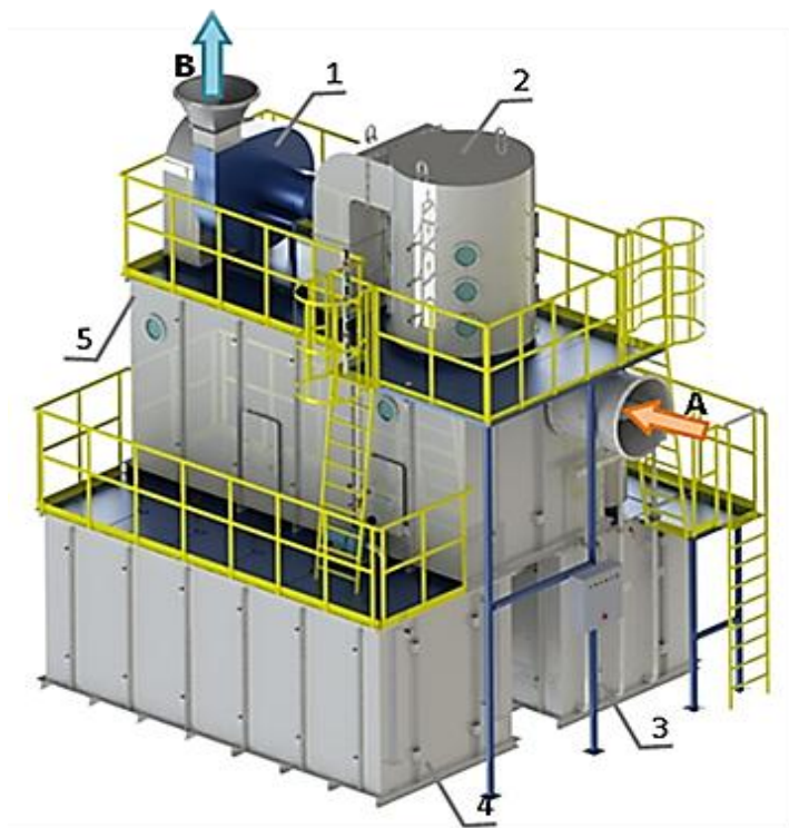
Рисунок 2 – Общий вид АБХУ производительностью по вентвоздуху 30 000 м 3 /ч
