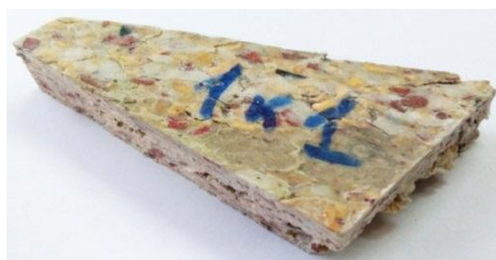
Вкладыш в пяточную часть обуви из отходов стелечных картонов и термопластических материалов
