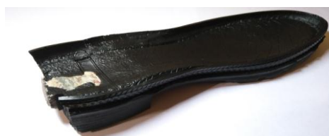
Подошва, полученная литьевым методом с вкладышем
