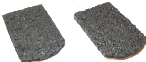
Образцы вкладыша из отходов полиуретана, ЭВА и отходов кож
