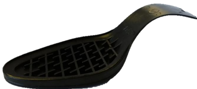
Рисунок 2 – Подошва, изготовленная из отходов пенополиуретанов с волокнистым наполнителем
